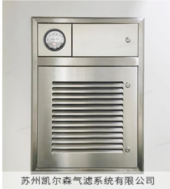
非单向气流是洁净室气流组织的主要采用方式，即高效送风口顶送（或侧上送）侧下回风；高效送风口布置形式为吊顶均布，或是布置于受保护的工艺生产线上方，回风口布置于侧墙下方。《医药工业洁净厂房设计规范》指出：回风口位置宜远离洁净工作台；易产生污染的工艺设备附近应设排风口；有局部排风装置或需排风的工艺设备，尽量布置在洁净室下风侧。为了保持房间气流稳定，不可将回风口随意布置于空余墙角或墙边，也不可将回（排）风口远离产生污染的工艺设备（如粉碎机等），不可布置的太少，回风速度不能过大。药厂洁净室送风和回风设计是影响洁净室是否达标的重要因素，送风和排风的合理设置，可以使房间达到正压或负压的受控状态。
